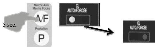
Laisser fonctionner l'ensemble au maximum 24 heures, faire une analyse manuelle du taux de chlore, pour stopper la chloration choc si besoin et revenir en mode automatique.
