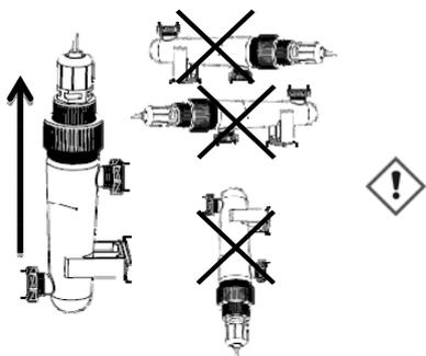
Si le système double collier est utilisé, il faut bien bloqué le serrage avant mise en place de la chambre.
