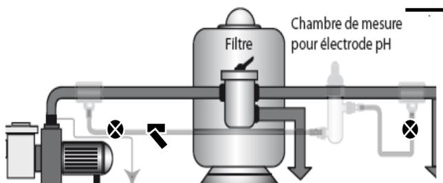
Le collier de prise en charge d'entrée est donc installé au refoulement de la pompe mais avant le filtre
