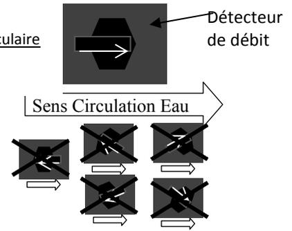
Positionnement Collier de prise en charge parfaitement axé sur trou D24 mm réalisé dans le tube :
