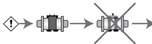
**i** L'eau doit circuler entre les plaques de l'électrode. Le flux de l'eau de la piscine doit arriver sur la tranche des plaques et non face aux plaques.
