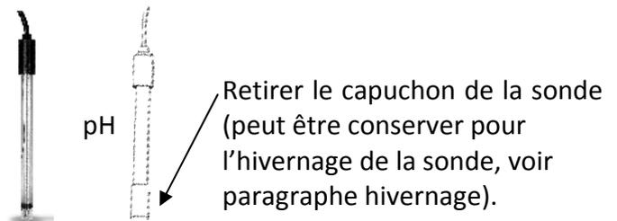
Insérer la sonde dans son raccord spécifique la faire plonger au maximum sans toucher le tube et reserrer le raccord sur la sonde sans forcer.
